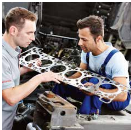
Reparação da cabeça do motor
